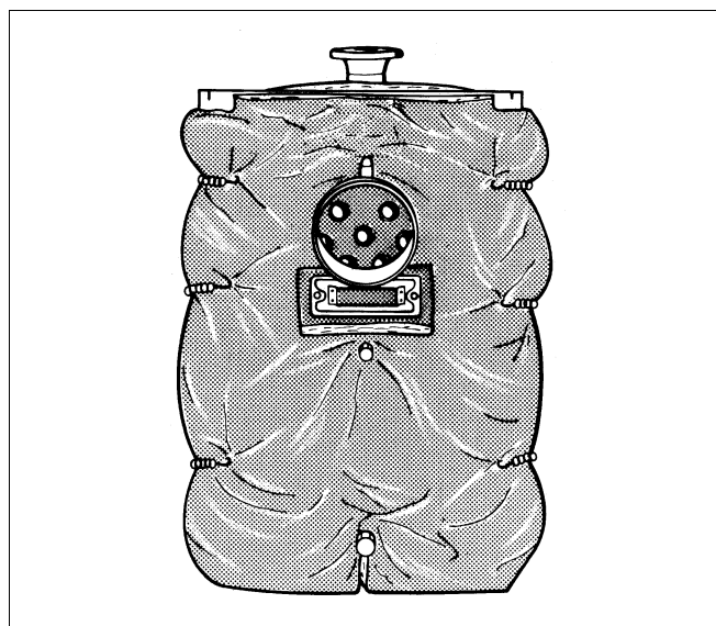
Fig. 9 Montaj izolație termică spate.
